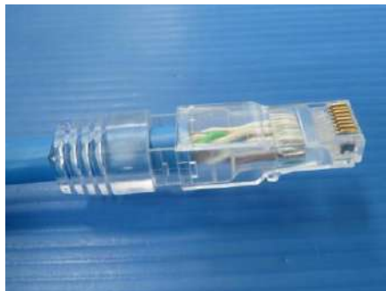
14. ガイドブーツを指で固定し、プラグ本体をカチッと音が鳴るまで押し込む ※ この際、ケーブルには力を加えないこと
