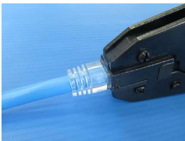
16. カシメ工具にセットし、リリースするまでカシメる ※ カシメ工具:PM-236Q1B-U
