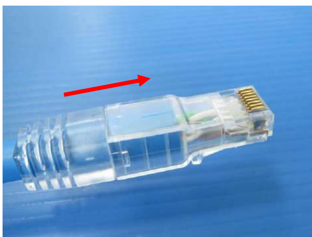
15. プラグ本体を指で固定し、絶縁体と外被がズレない様にケーブル全体をしっかりと固定して押し込む ※ 右上写真のように絶縁体先端がコネクタ先端まで挿入されていることを確認する
