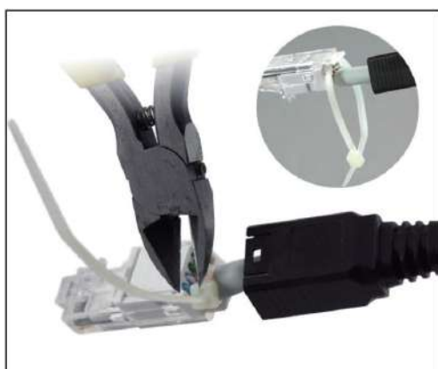
5.ケーブルタイをコネクタに通しケーブルとコネクタを 一緒に締め付ける ※結び目はコネクタの上側にすること
